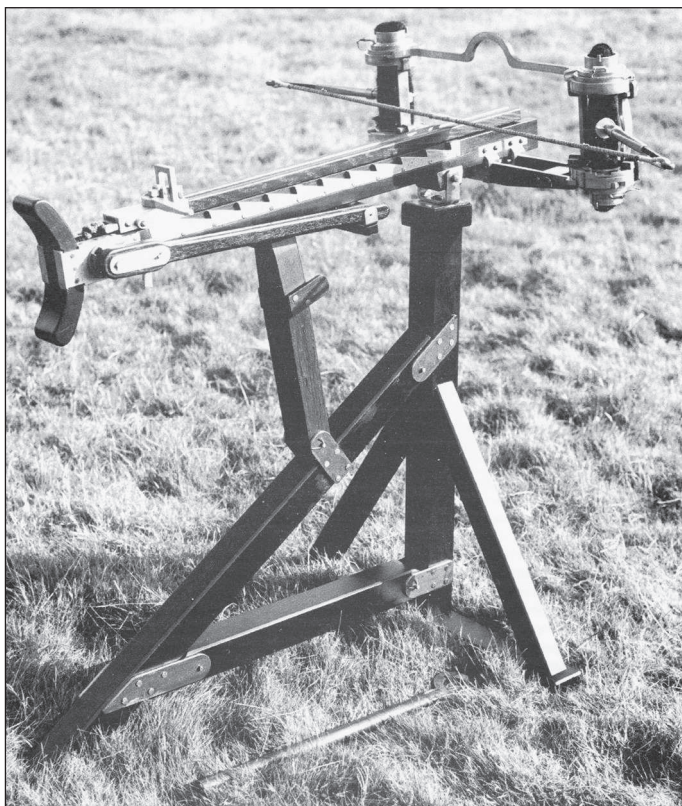
Рис. 47. Реконструкция хиробаллистры Герона по А. Уилкинсу. Воспроизведено по: Wilkins 1995: 47, fig. 24.
