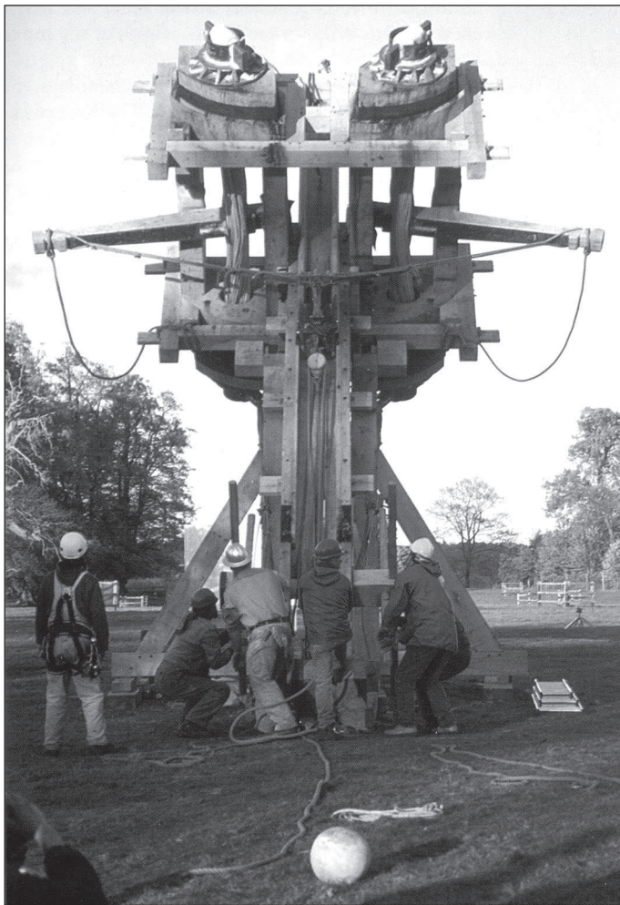
Рис. 51. Реконструкция баллисты (паллинона) для телекомпании ВВС, предназначенной для метания каменных ядер весом в один талант (26,2 кг). Воспроизведено по: Macdonald, Mullen, Wilkins 2002: 15.
